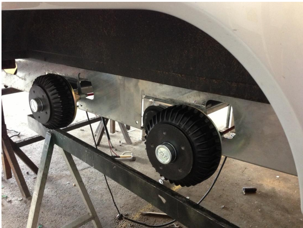
Akslerne monteret, der skal bruges fælge med 5 bolte.
